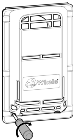
Figura 11 Installazione e fissaggio del coperchio condotto del fumo
