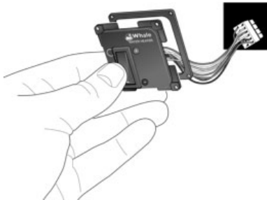
Abb. 17 Einsetzen des Schalters
