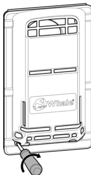
Abb. 11 Montage und Sicherung der Abzugabdeckung
