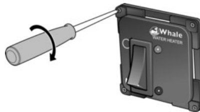
Abb. 18 Montage des Schalters
