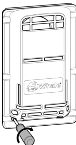
Fig. 11 Installation et fixation du couvercle du conduit d'évacuation des gaz
